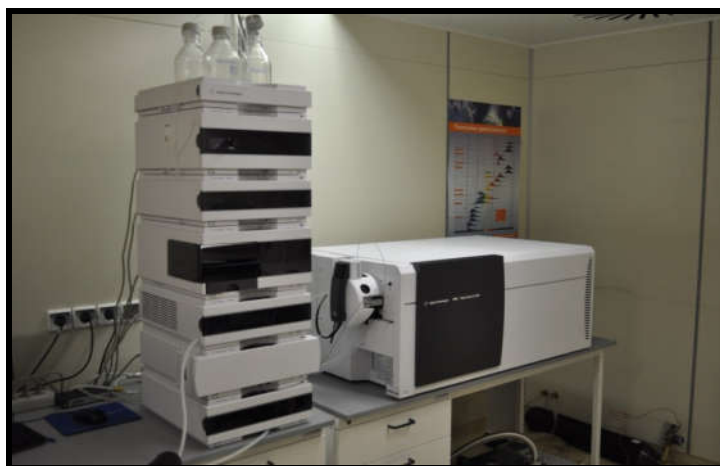
Рисунок 3. Высокоэффективный жидкостный хроматограф «LC 1260 Infinity» (Agilent, США) с масс-спектрометрическим детектором «TripleQuard 6460» с системой ионизации «Agilent Jet Stream-электроспрей» (AJS ESI) (Agilent, США).
